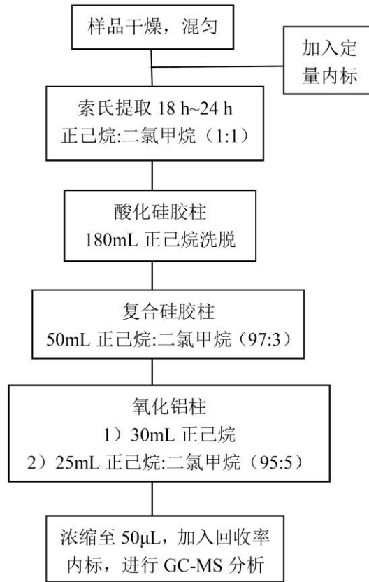
图 D.2 同位素稀释气相色谱-质谱联用仪测定食品中多氯联苯流程图
